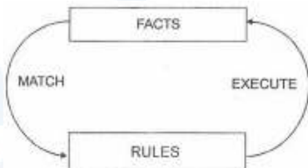
(شکل ۵-۸) الگوی استنتاج در یک سیستم خبره مبتنی بر قانون
